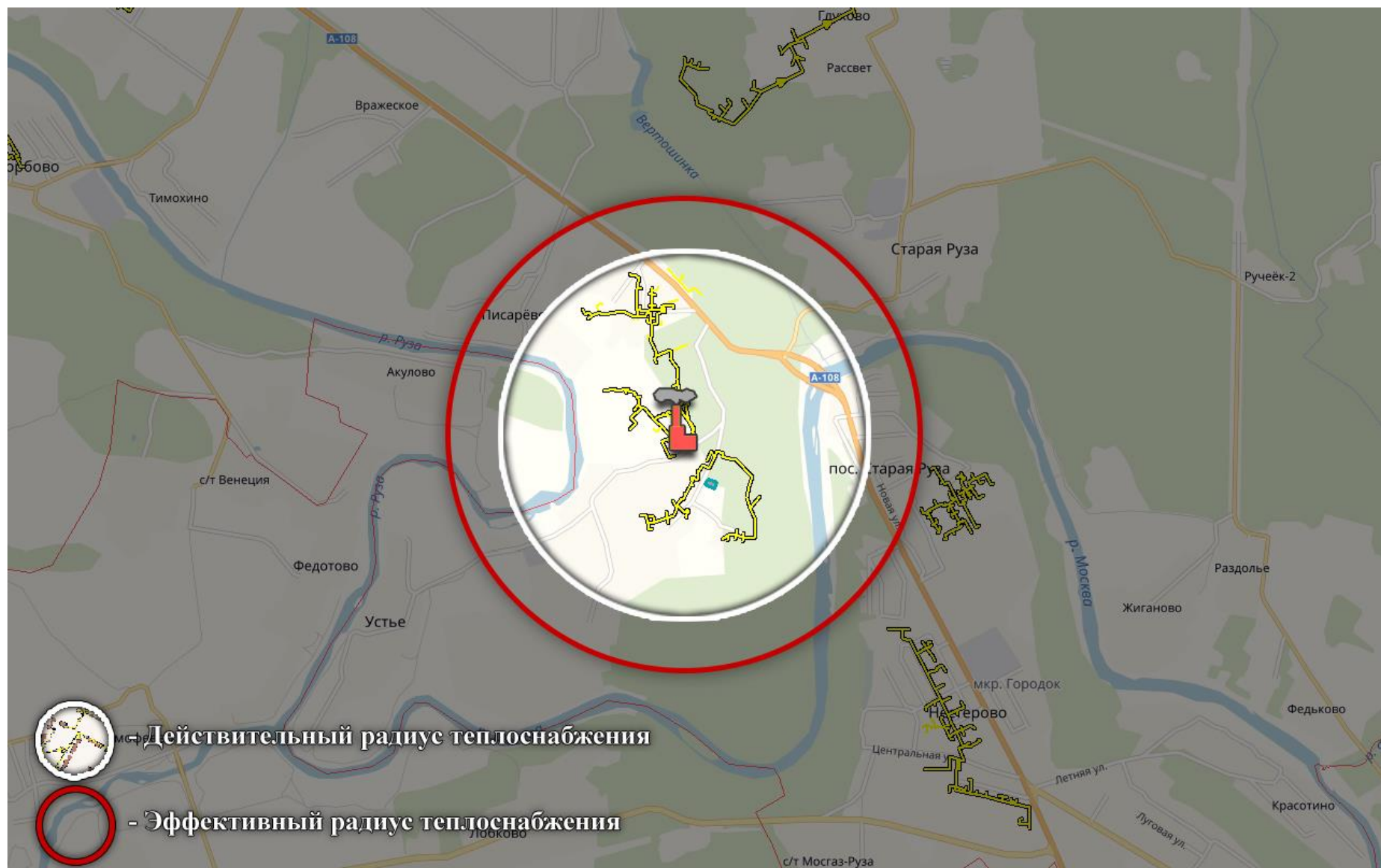
Рисунок 2.97 - Действительный и эффективный радиусы теплоснабжения котельной «Санаторий Дорохово»
