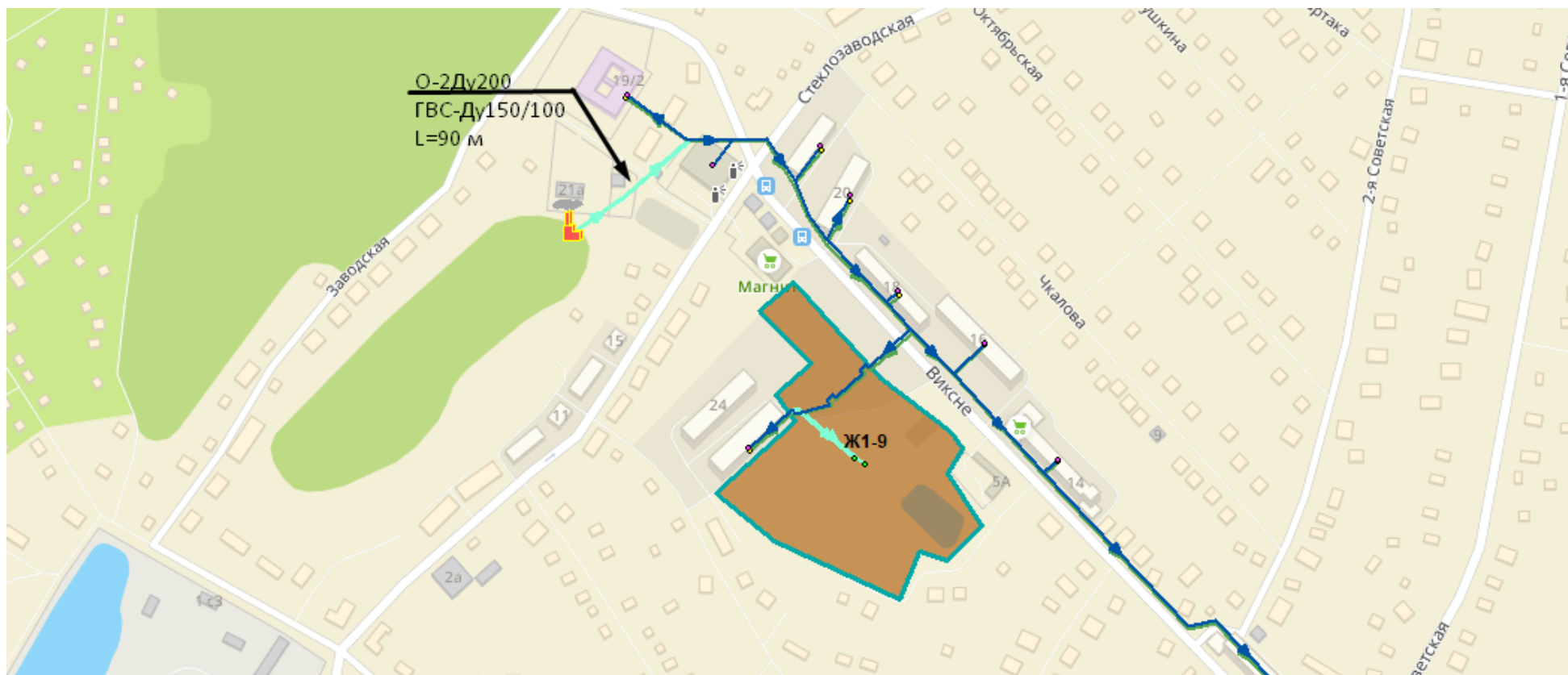
Рисунок 6.5 – Строительство тепловых сетей для подключения перспективной БМК п. Дорохово, ул.Стеклозаводская, д.21Б
