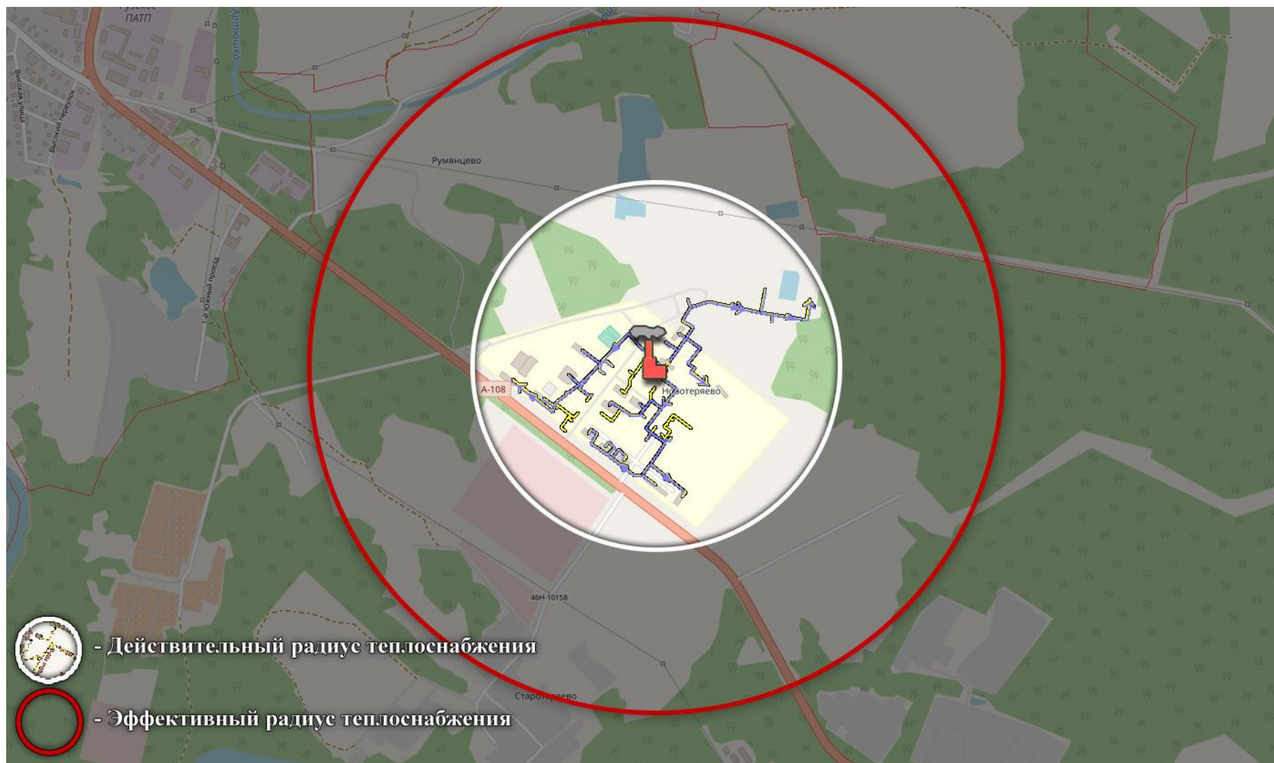
Рисунок 2.92 - Действительный и эффективный радиусы теплоснабжения котельной п. Новотеряево ул. УЦ ГУВД МО
